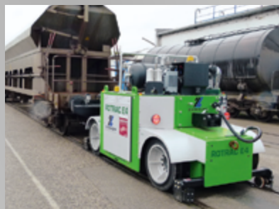
ROTRAC E4 bis 500 t Anhängelast
