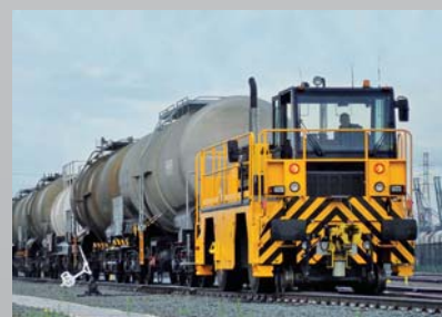
ROTRAC RR Для прицепного веса до 4000 т.
