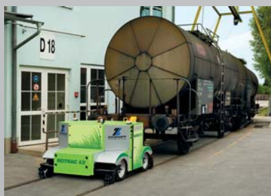
ROTRAC E2 Для прицепного веса до 250 т.
