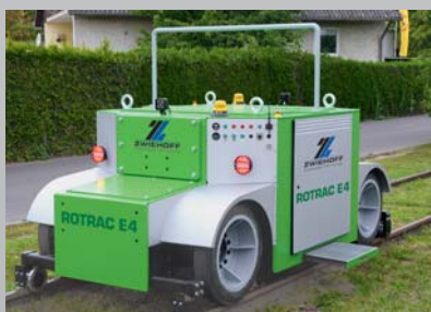
ROTRAC E4 Для прицепного веса до 500 т.
