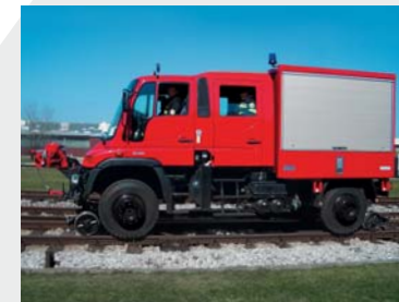
Vehículo bivial de auxilio Treno di soccorso strada/rotaia
