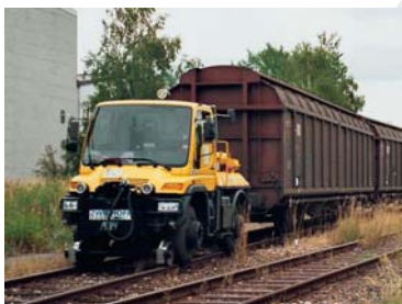
Vehículo de maniobra Unimog Deviatore Unimog
