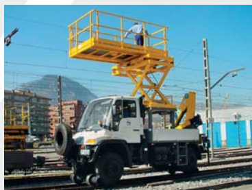
para montaje y mantenimiento de catenaria per il montaggio e la manuten- zione della linea di contatto
