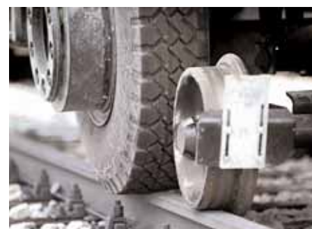
Hoher Reibwert: Gummirad auf Stahlschiene sorgt für maximale Traktion – auch bei schweren Lasten und winterlichen Verhältnissen
