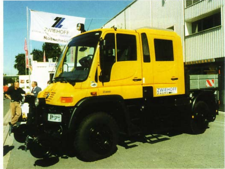
Von den Feuerwehren sehnsüchtig erwartet: Die neue UNIMOG-Baureihe (U300/400/500) gibt es jetzt mit einer von Zwiehoff entwickelten Doppelkabine.
