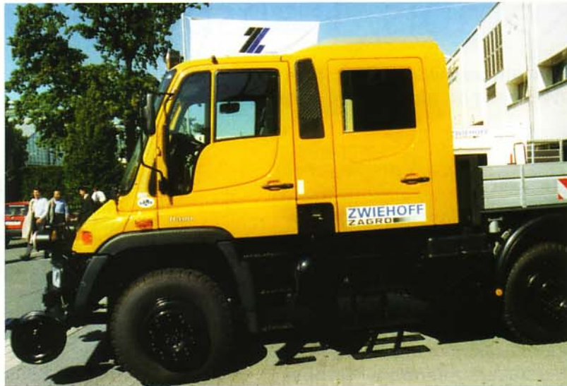
Da UNIMOG ab Werk keine Doppelkabine anbietet, hat sich die Firma Zwiehoff jetzt der Sache angenommen. Für den U 300/400/500 gibt's ab sofort eine zweites »Abteil«.
