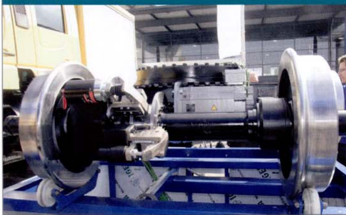
BILD 4: Für Zwei-Wege-Fahrzeuge wurde ein neuer elektrischer Antrieb vorgestellt
