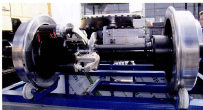
Abb. 10: Fahrwerk für Zweigegefahrzeuge mit elektrischem Antrieb
